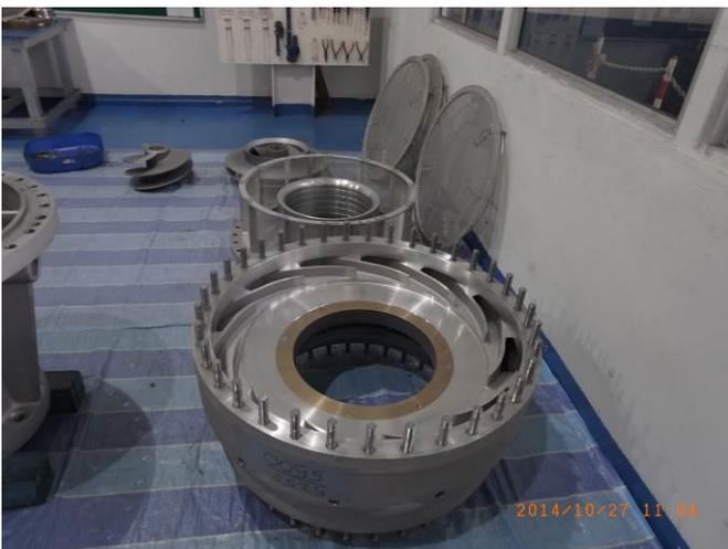
拆下之PUMP CASING
