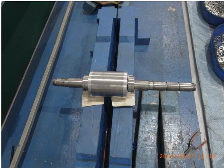
CARGO PUMP之驅動馬達轉子(CARGO PUMP SHAFT) 抽出進行BEARING更換作業
