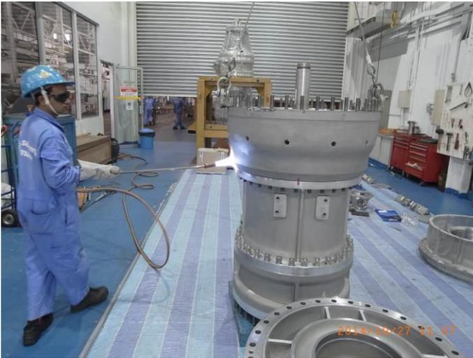
拆卸PUMP CASING
