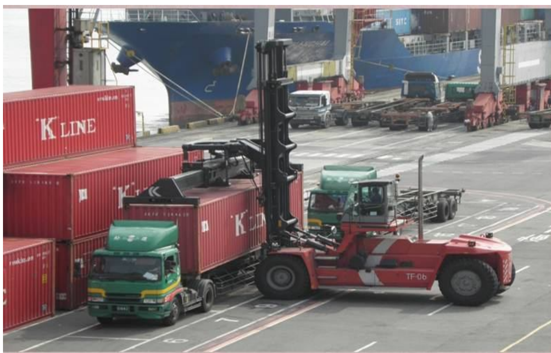
圖 3 重櫃堆高機作業情形
