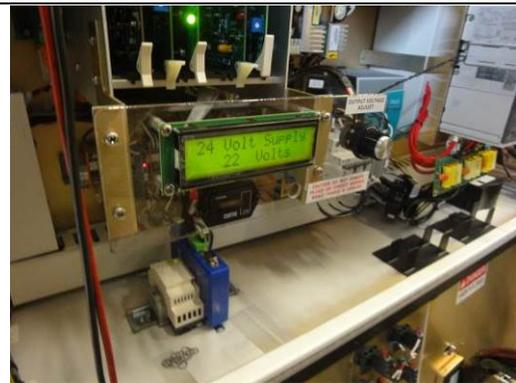
控制電壓測試(24V)
