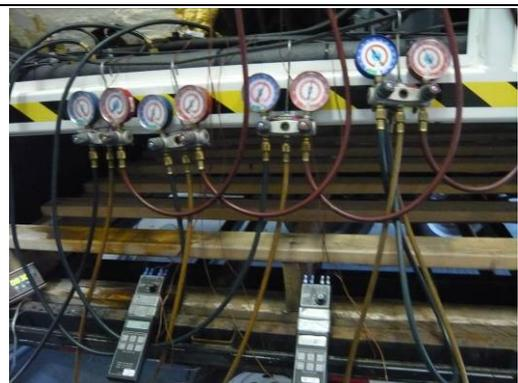
冷媒壓力量測
