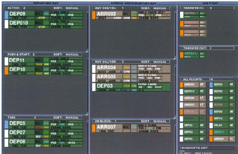
塔臺自動化系統展現不同狀態的航班資訊
