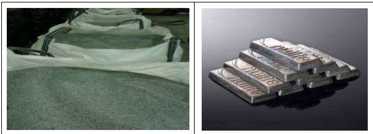
圖 14 不含鉛之玻璃(左圖)及自行精鍊後之鉛錠(右圖)
