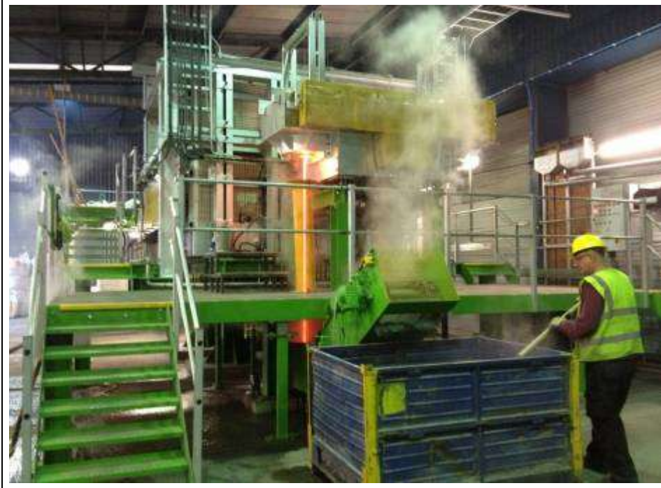
圖 13 Nulife Glass 公司透過自行研發的高溫電熔爐
