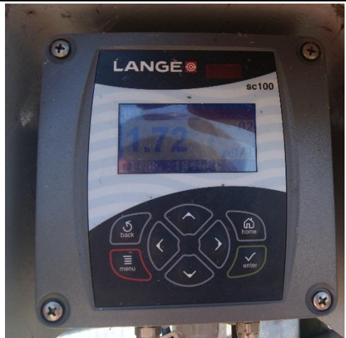
線上監測溶氧測定儀
