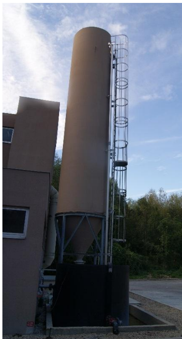
拌合設施(左)沉澱池底泥添加石灰後脫水(右)
