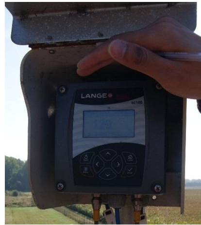
線上監測電位差測定儀
