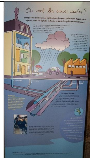
法國採雨、污水合流式下水道，其中下水道內亦含飲用水輸送管線
