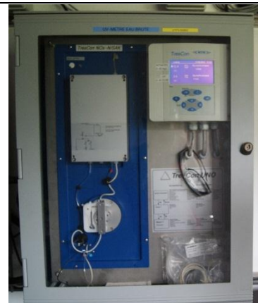
硝酸鹽(Nitrate)線上即時監測儀 (單位：mg/L NOx)
