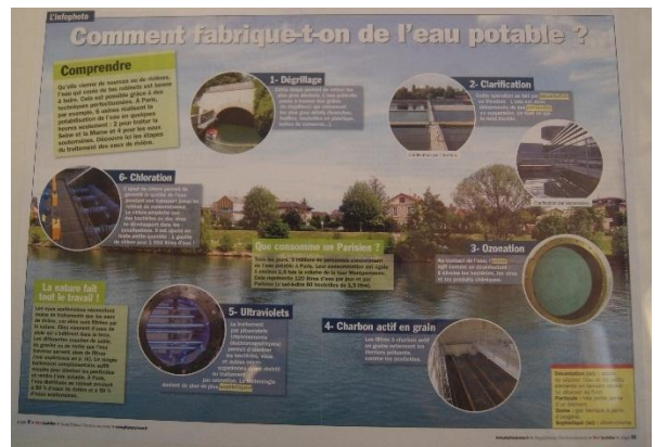
自來水淨水場各處理單元 (高級處理幾乎為法國各淨水場內基本配備)
