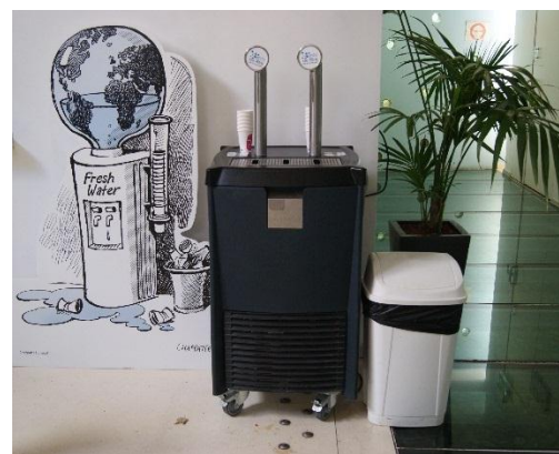
館內現場製造氣泡水飲水機台 (高壓灌入 CO 2 形成無味碳酸水)
