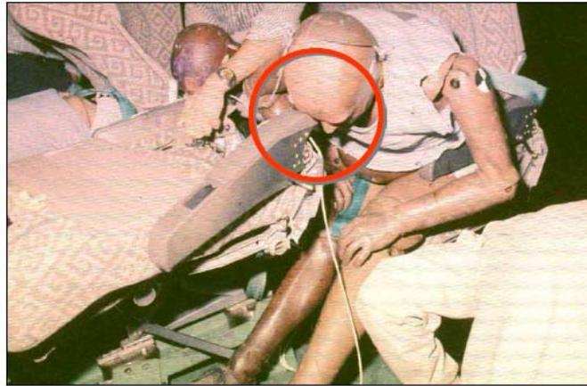
圖 13A. 經濟艙座椅動態測試結果-前座扶手造成人員傷害
