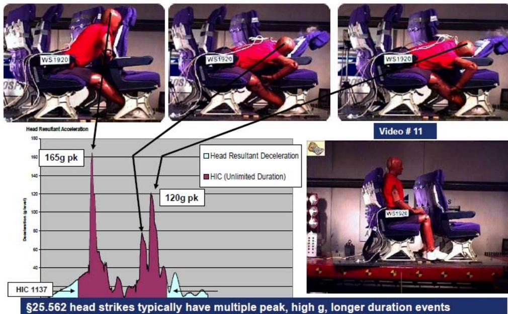
圖 13B. 經濟艙座椅動態測試結果-前座扶手造成人員傷害(造成 HIC 超標>1000)
