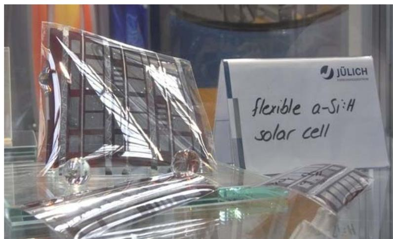
圖 3.5.2 軟性薄膜 Si 太陽電池模組。
