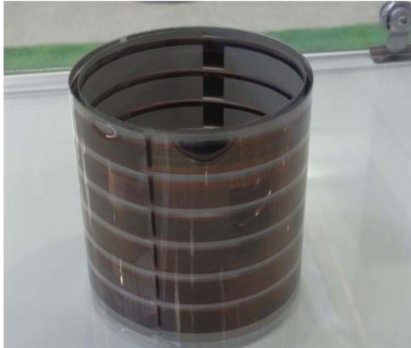
圖 3.5.1 利用德國 micro FLEX™ 公司先導型量產線印製之 OPV 太陽電池模組。
