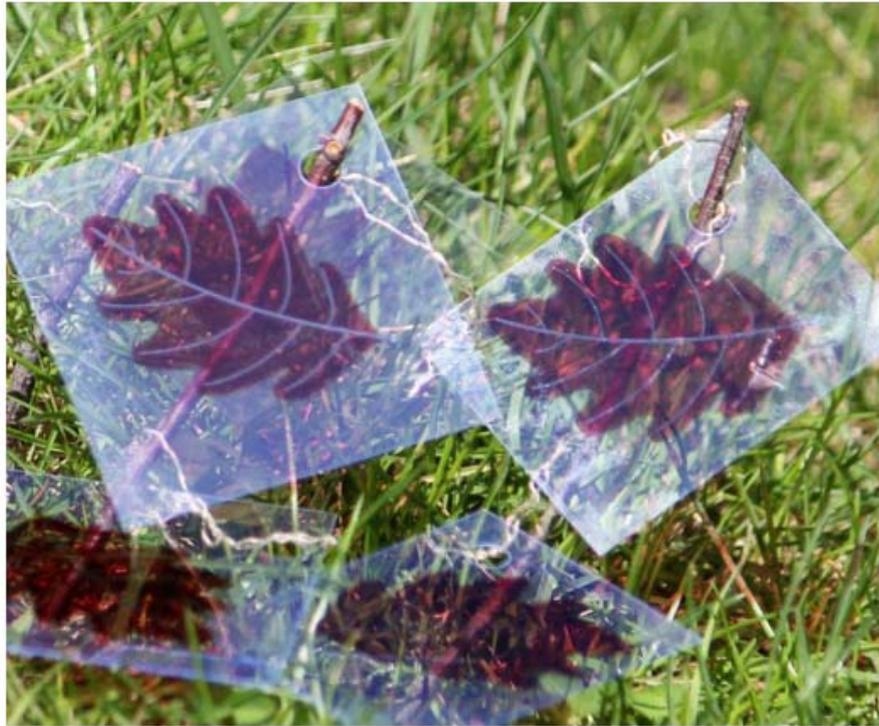
圖 3.2.11 噴墨印刷製程製備不同圖案之 OPV 元件。
