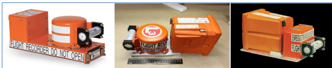
圖 3.4-1 (左) FA2100 CVR，(中) FA5000 CVR，以及 (右) FA5001 座艙語音與資料紀錄器 (CVDR) 之外觀比較
