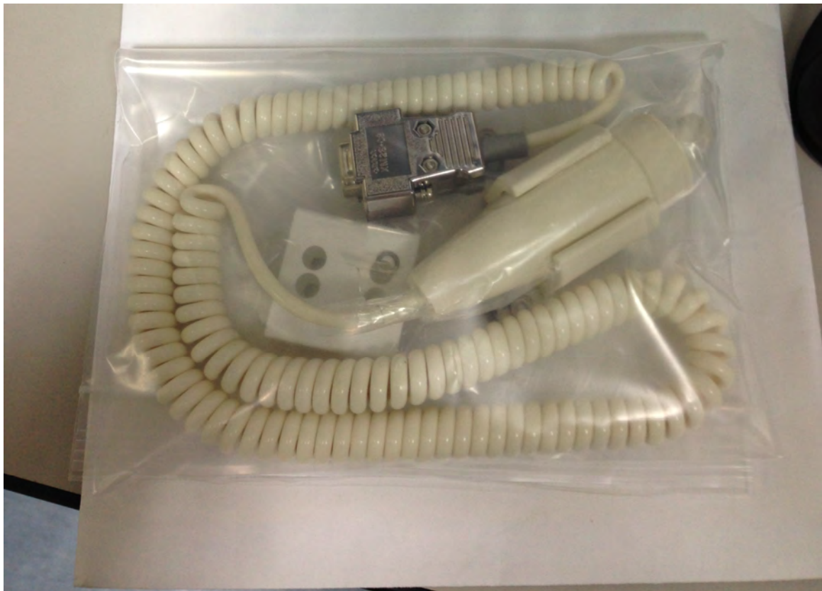
圖六、X 光高壓產生器之兩段式手持開關
