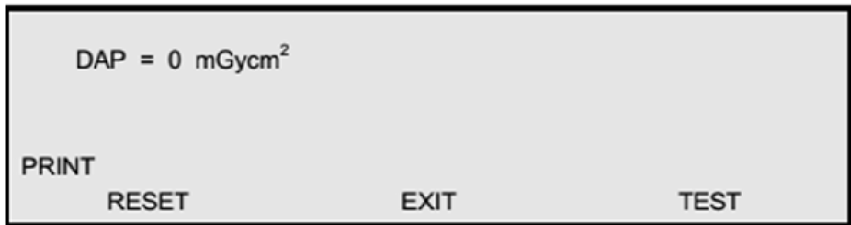
圖八、劑量面積乘積量測結果可顯示於 X 光高壓產生器操控台之屏幕
