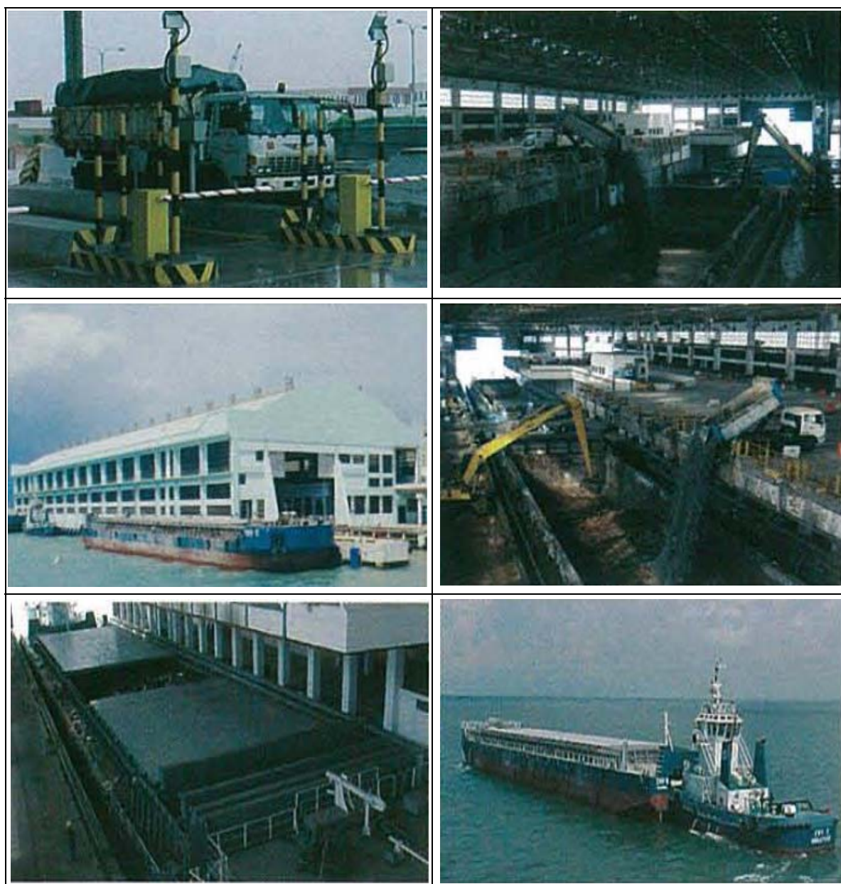
圖 38 垃圾傾倒至駁船上之作業照片(圖片來源：國家環境保護署 (NEA) 提供)
