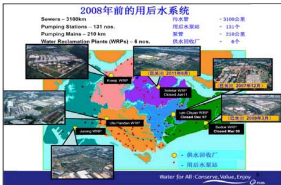
圖 2 新加坡 2008 年以前污水下水道系統圖 (圖片來源：新加坡公用事業局(PUB)提供)
