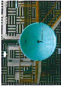
楕円体収音装置 φ1.3m Elliptical acoustic mirror φ1.3m
