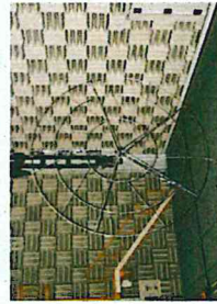
ビームフォーミングホイールマイクロホンアレイ(左: φ1.0m, 右: φ4.0m) Beamforming wheel array microphone (Left: φ1.0m, Right: φ4.0m)
