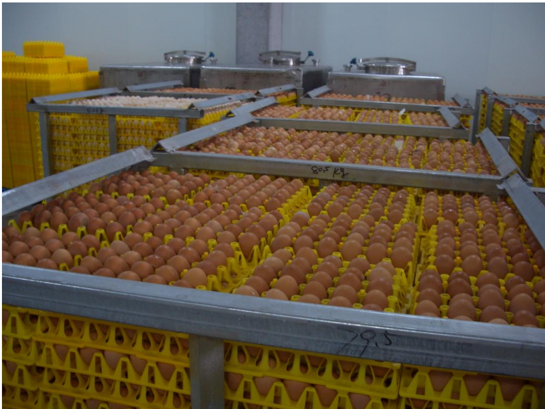
液蛋工廠內的塑膠蛋盤及裝載方式
