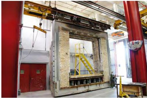
承重牆試體框及其下方加載設備
