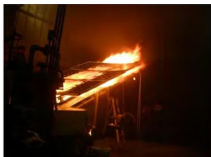
UL 790 光電板系統耐火測試
