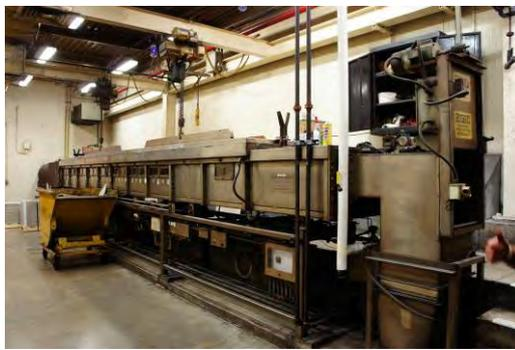
ASTM E84 試驗設備
