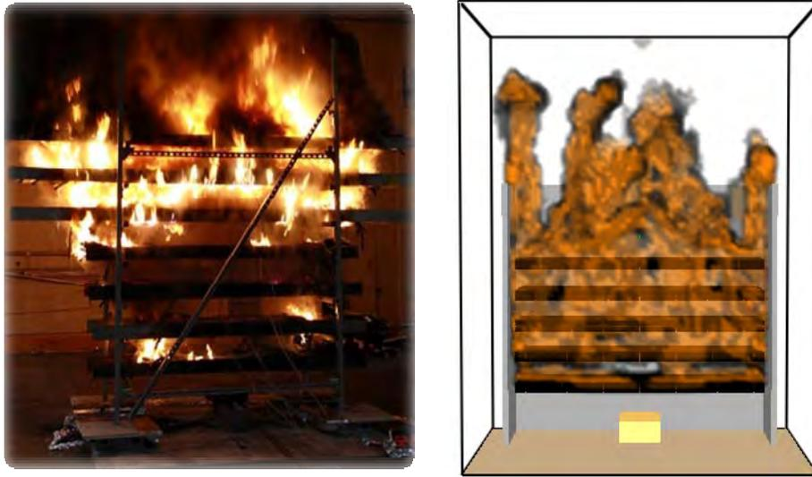
VTT的電纜熱裂解燃燒模擬
