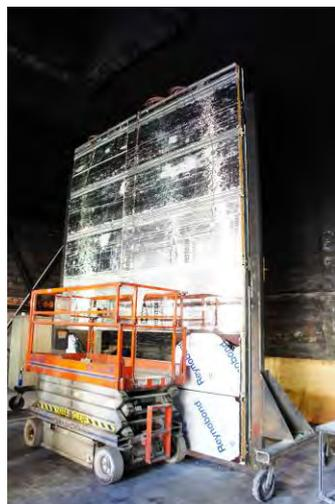
NFPA 285 外牆延燒試驗設備及試體
