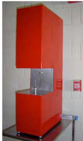
微燃燒量熱儀 Micro-Combustion Calorimeter，MCC
