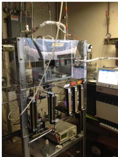
圖六 固定床氣化爐週邊設備
