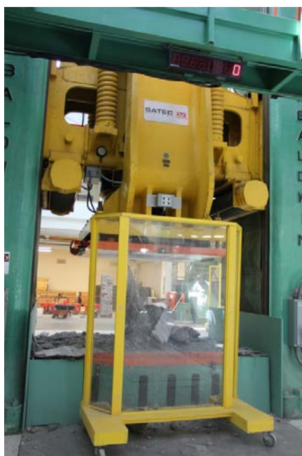
大型混凝土圓柱抗壓試驗(500萬磅抗壓機)的試驗結果照片-混凝土試體已破壞
