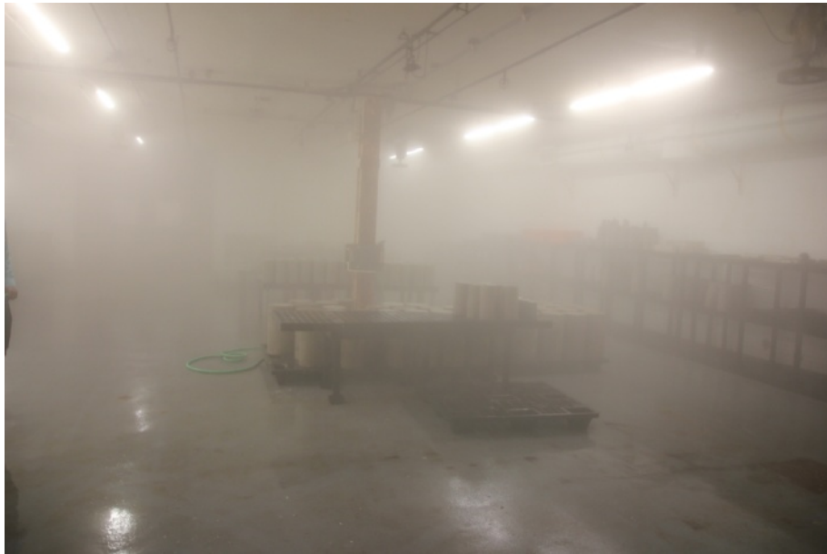
混凝土試體蒸氣養護室照片
