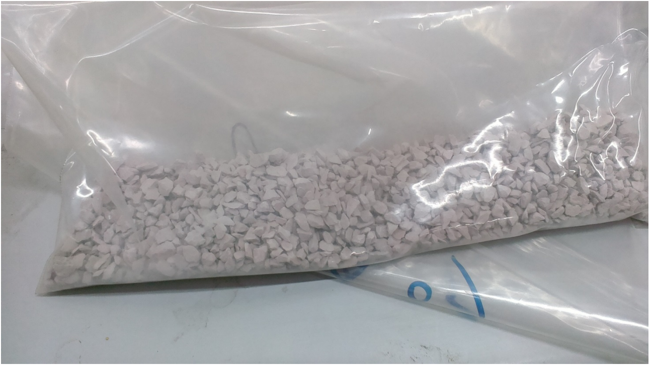
圖 12：大型台架試驗膨潤土填料
