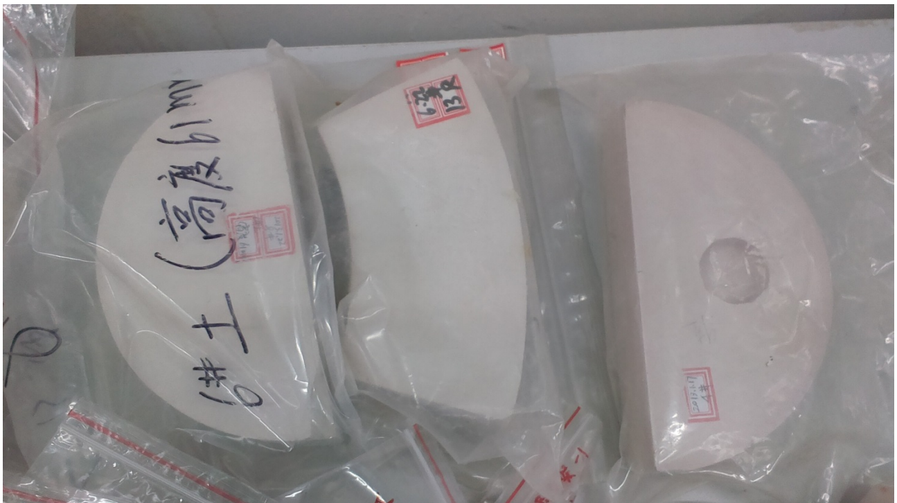
圖 11：大型台架試驗之膨潤土塊體
