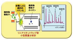
質量分析法により爆発物分子をイオン化し、そのイオンの 重さによって爆発物を同定
