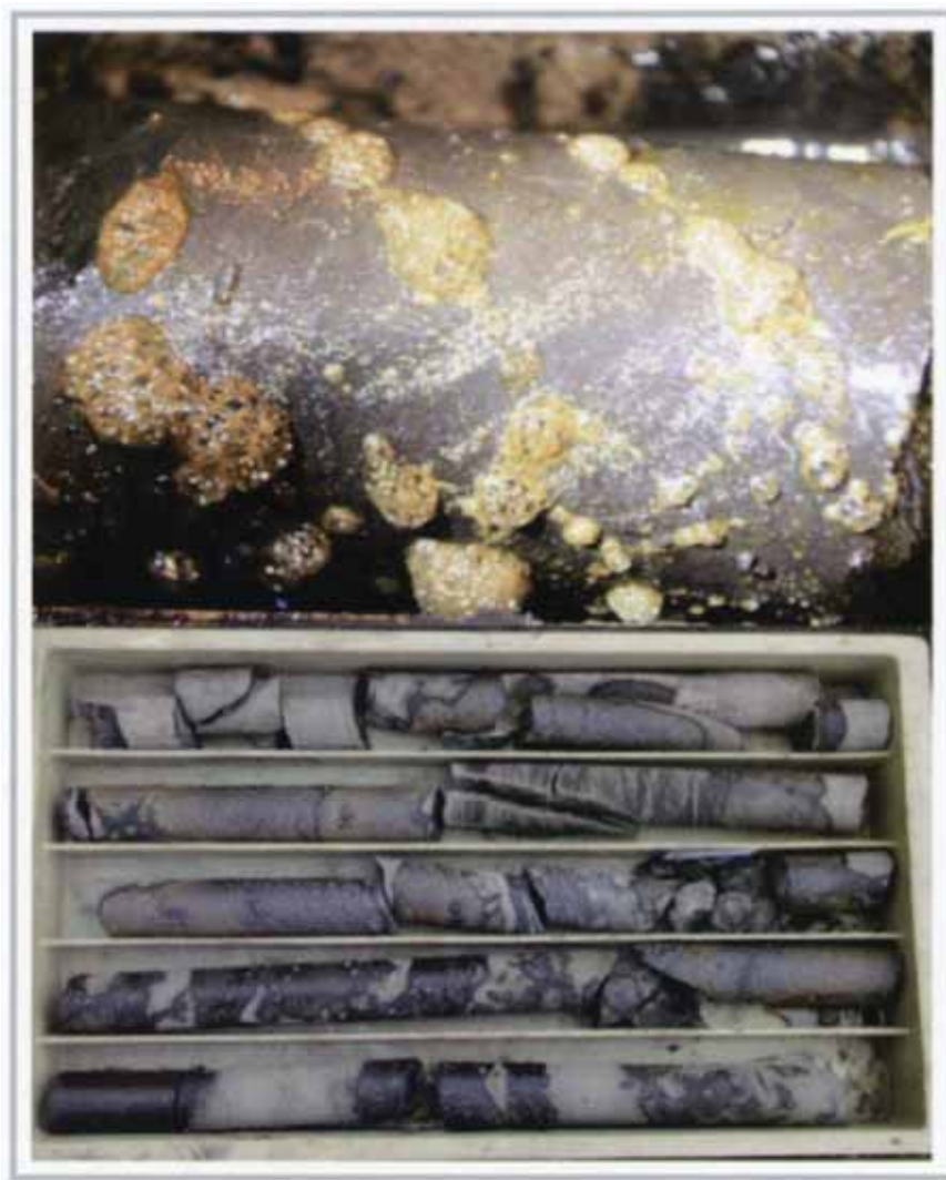
附件4-圖8、中國大陸祁連山永凍層地區DK-9井位在362-370 m井段的岩心標本照片（下圖），此段岩心屬於侏羅紀砂岩。上圖為所含原油滲到岩心表面的照片。
