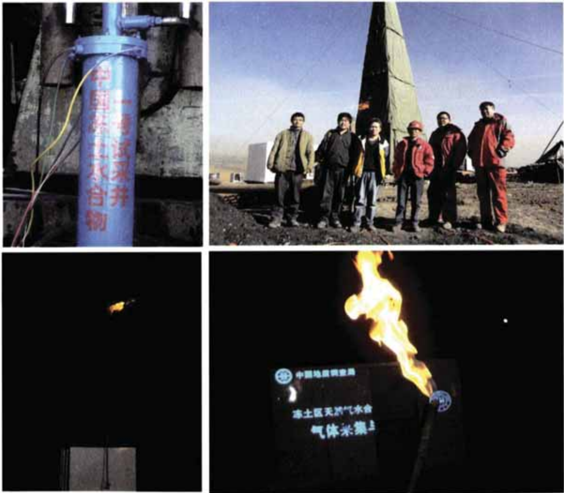
附件 4-圖 14、祁連山永凍層地區 DK-8 井之天然氣水合物試採現場與成功採出甲烷的試氣燃燒情形。
