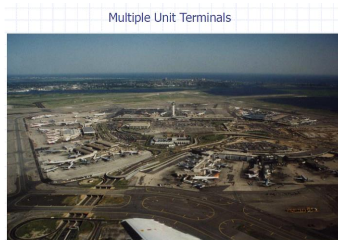
圖3.16 JFK機場，Multiple Unit 航廈配置圖
