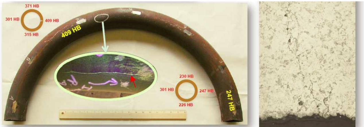
圖 58 應力腐蝕破壞
