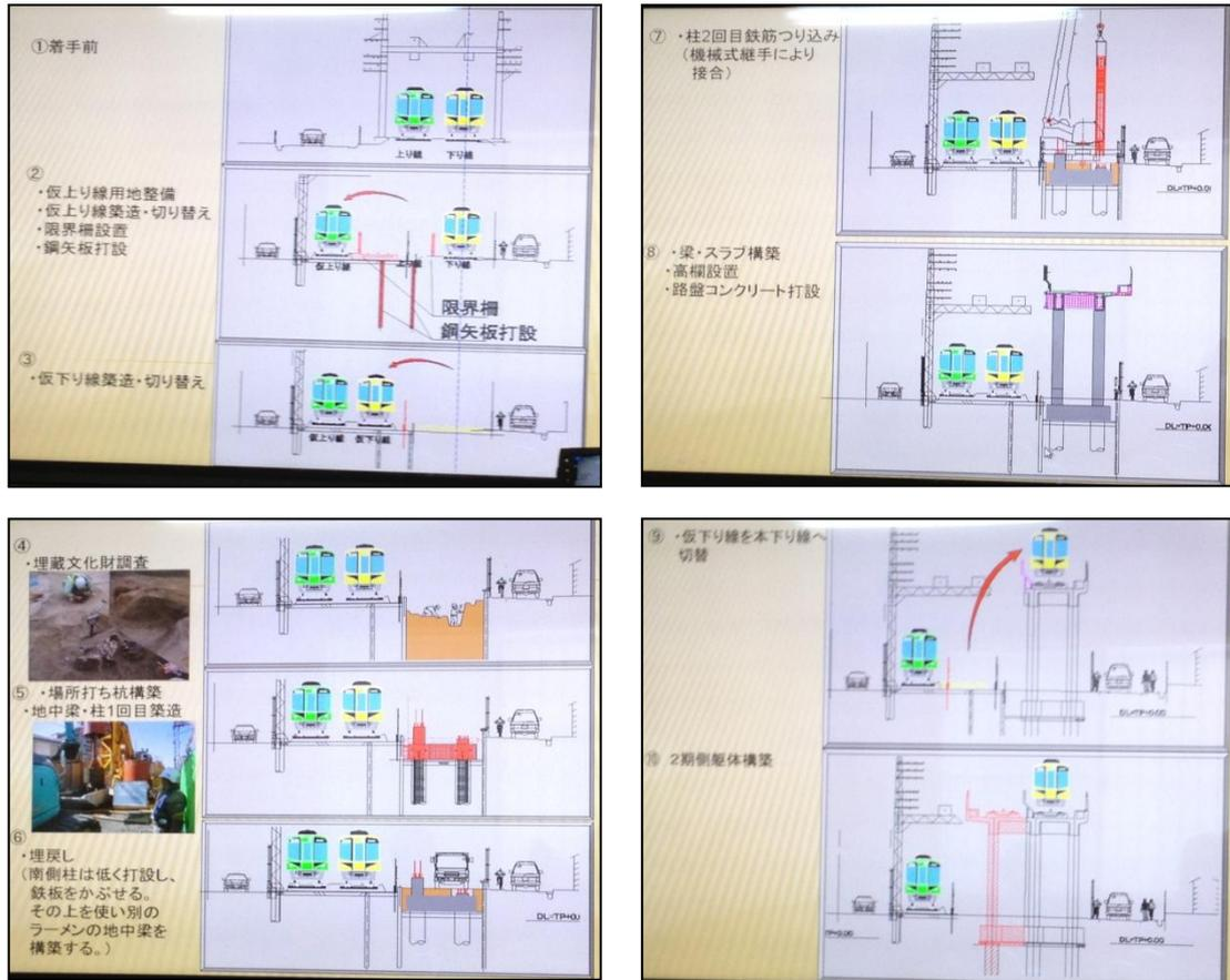
圖 2.2 阪神電鉄~青木高架施工程序
