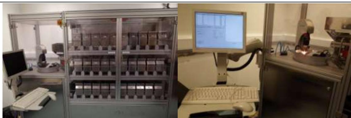
圖 32. 實驗室參觀。種子樣品 3D 攝影掃描器，可進行初步的分析送驗樣品是否符合可接受檢驗的樣品。
