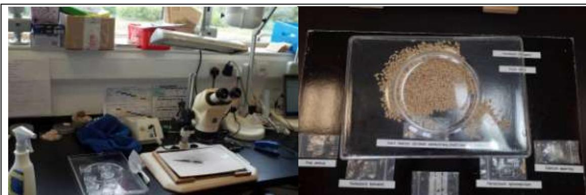
圖 27. 實驗室參觀。潔淨度分析實驗室：左圖為淨檢台及顯微鏡設備；右圖為提供潔淨度分析之參考樣品。
