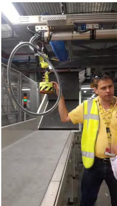
圖 4-24：以吸盤方式提取行李箱裝載
