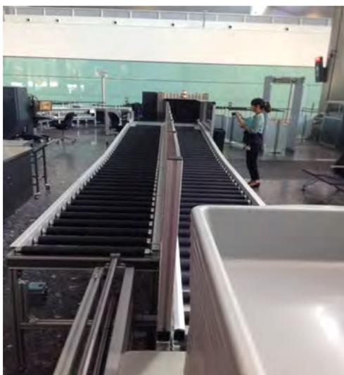
圖 3-15：每一條安檢線設有兩條滾帶，無疑似危安物品可放行之手提行李部分，旅客可直接領取，另有疑似危安物品之手提行李將會被自動移至另一條滾帶，再由安檢人員逐件進行複檢
