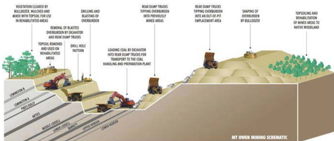
圖 10 採礦前開發整地與採礦後的土地整復利用傳統程序布置。
