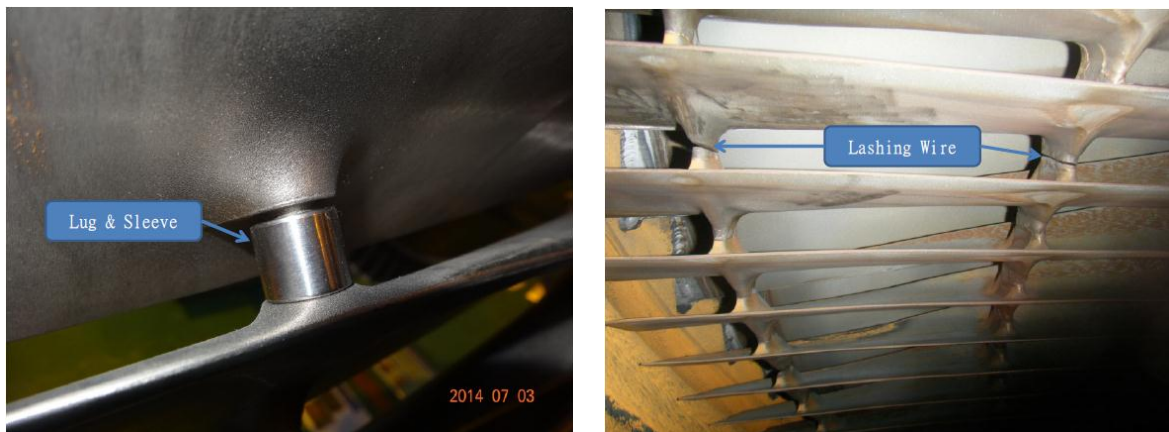
【圖十二】低壓末二級葉片的葉中新(Lug & Sleeve)、舊(Lashing Wire)機組不同類型
