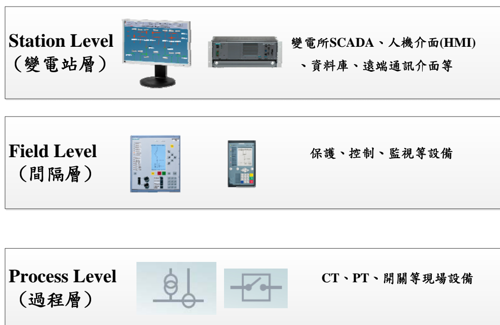
圖二 IEC 61850 變電站自動化系統之分層架構圖
