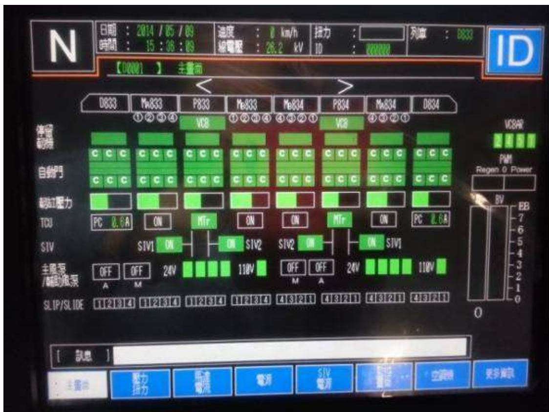
圖 4.42 DDU 顯示 TCMS 收集之列車監視情報
