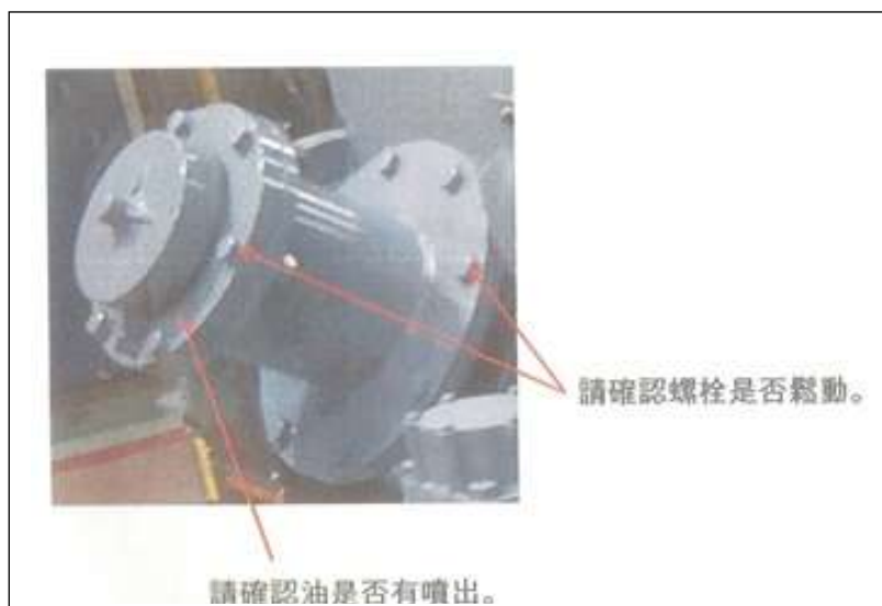
圖 2.31 釋壓閥檢查重點示意圖
