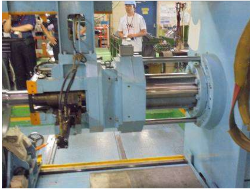
圖 3.22 車輪壓入步驟圖 8
