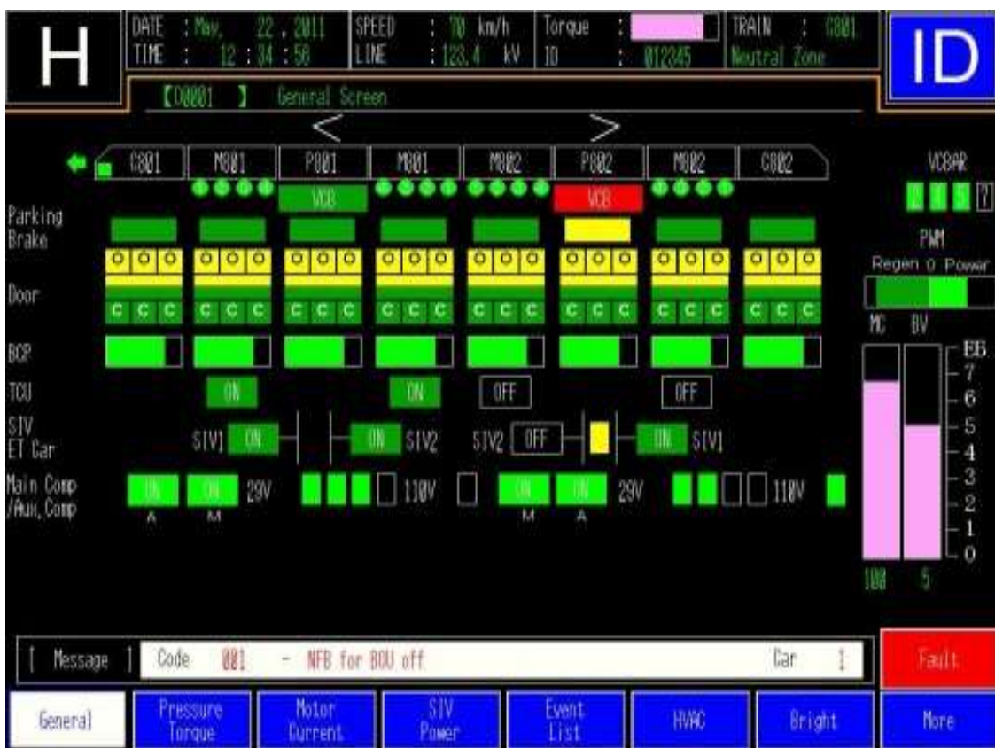
圖 4.43 DDU 顯示故障狀態與故障碼
