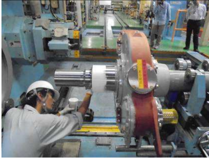
圖 3.16 車輪壓入步驟圖 2
