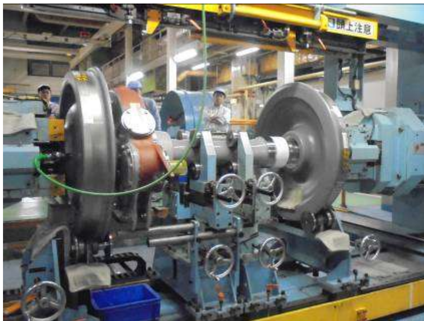
圖 3.18 車輪壓入步驟圖 4
