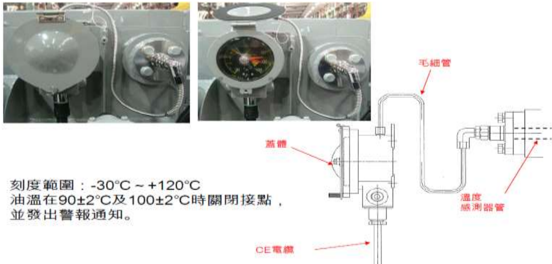
圖 2.19 溫度繼電器外觀與構造圖
