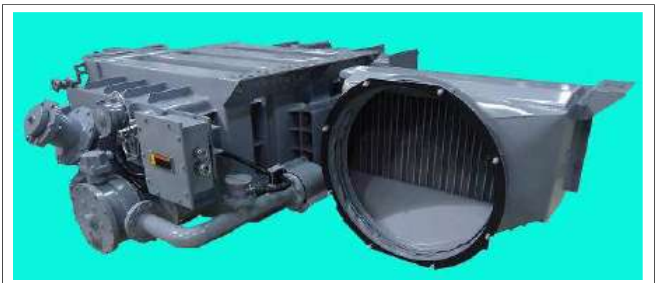
圖 2.3 主變壓器外觀圖
