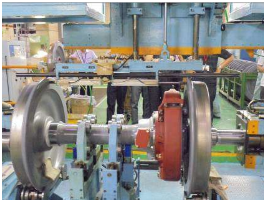
圖 3.21 車輪壓入步驟圖 4
