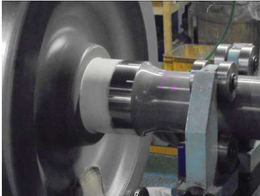
圖 3.20 車輪壓入步驟圖 6
