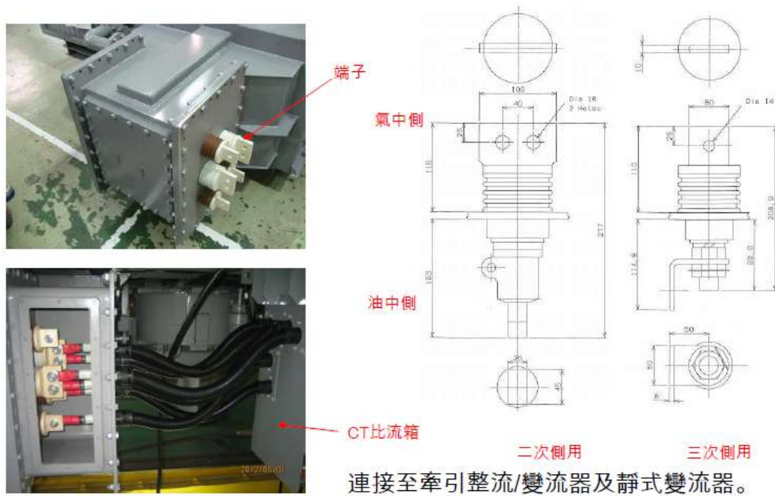
圖 2.14 低壓端子連結方式與構造圖
