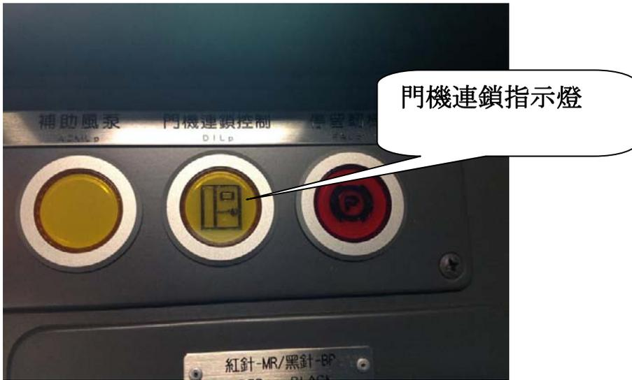
但為了防止 DIR 線圈燒損或某一個查證電路接點不良，雖然門都確認關妥，還是不能出力，此時可以扳動門機隔離開關 DIRS 作為故障處理，但千萬要注意扳動此開關前務必請列車長確認車門均關妥，才能拉動電門使車輛移動。(參考電路圖 page 27)
