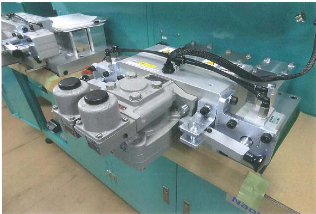
圖 3.6.6 軟機系統閥類測試平台
