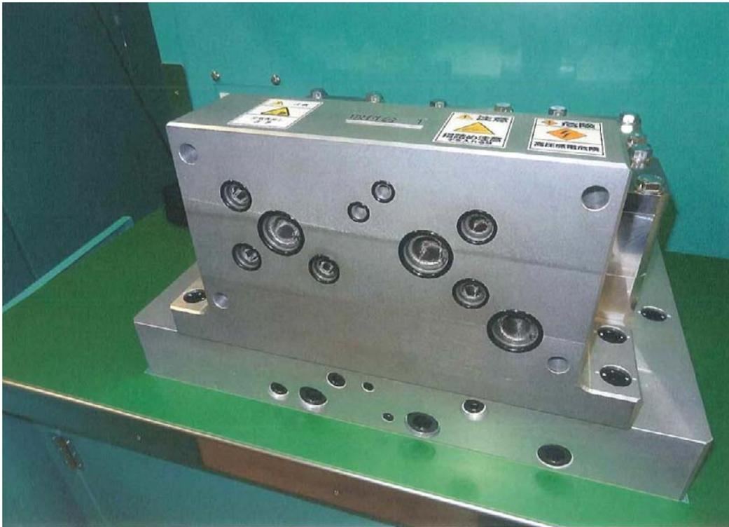
圖 3.6.4 軛機系統閥類測試面板
