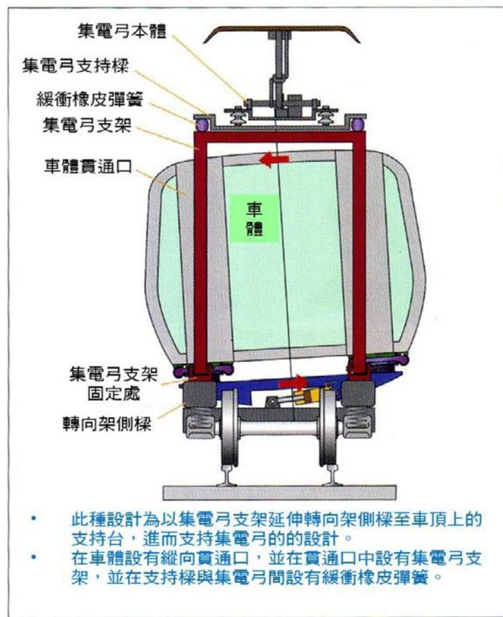
圖 4.1.9 解決滾筒式傾斜系統集電弓離線問題方法之一：集電弓支架方式
