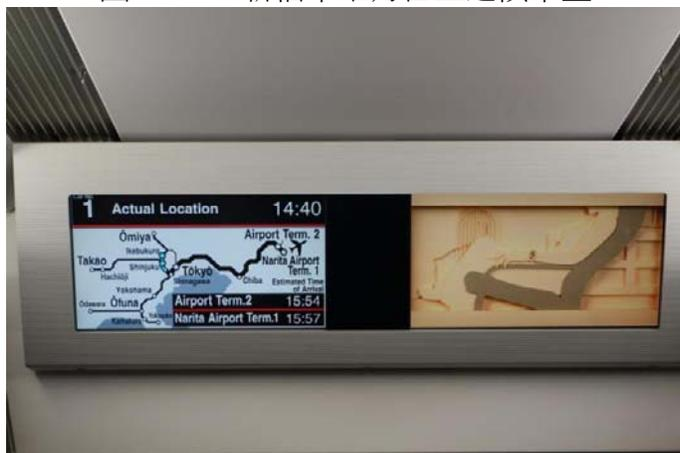
圖2.2.43 成田特快列車車箱內部可顯示豐富乘車資訊之雙 LCD 旅客資訊系統
