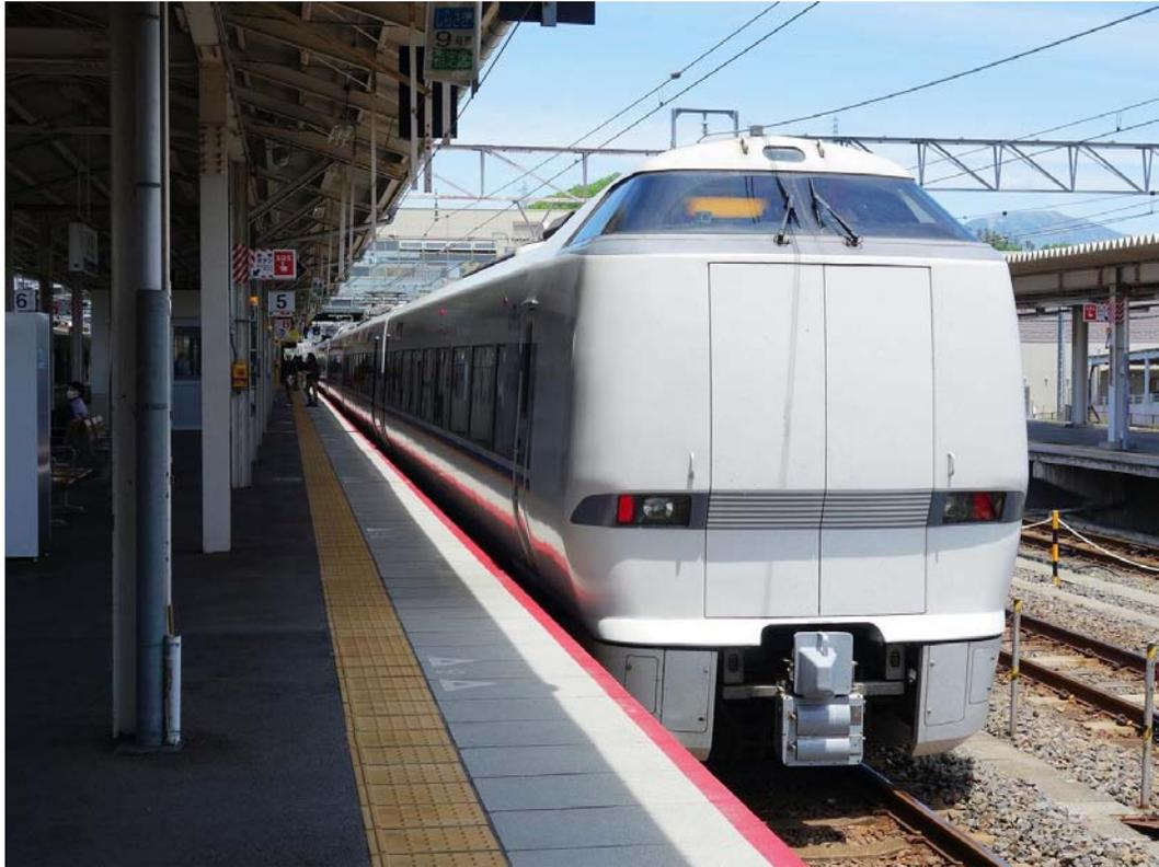
圖 4.2.1 採高運轉台設計的 JR683 系
