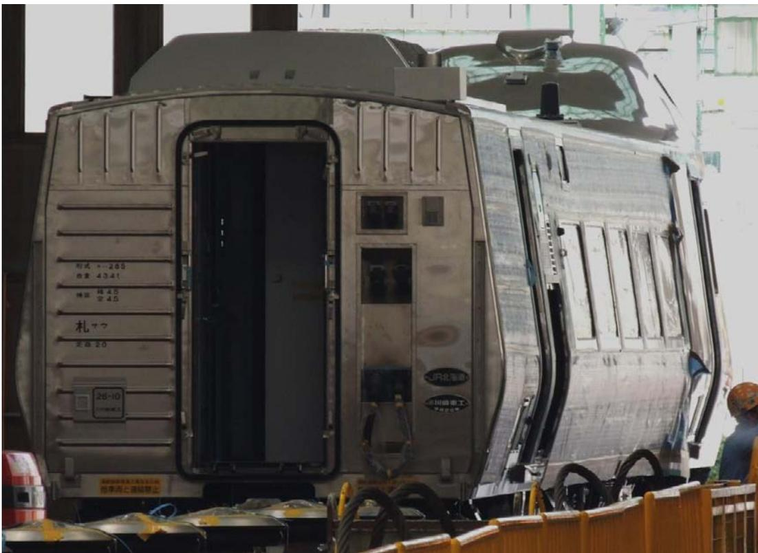
圖 4.1.14 為了使車體在最大傾斜 8 度時不致於超出車輛界限，車身的上下均向內縮採用類似菱形的設計
