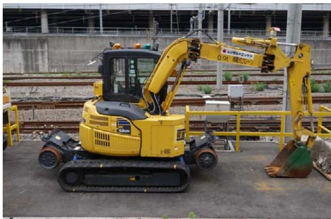
圖2.2.40 新宿站內配有鋼輪之鐵道工程機具
