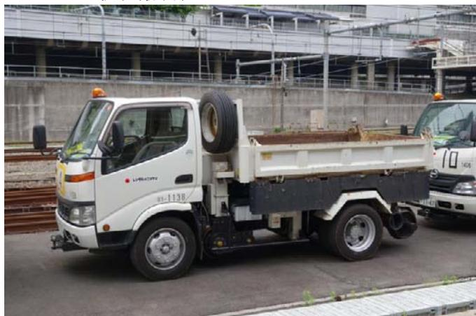
圖2.2.39 新宿站內配有鋼輪之鐵道工程車輛
