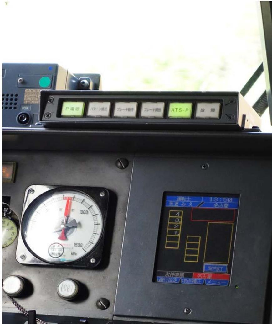
圖 4.2.5 由 6 個燈號所組成的 ATS-P 介面。由右到左分別為電源、警告、作用、解除、系統狀態、故障等
