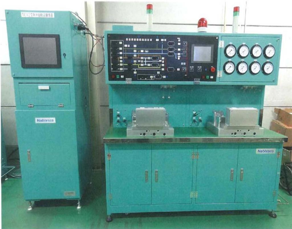
圖 3.6.3 軛機系統閥類測試機外觀
