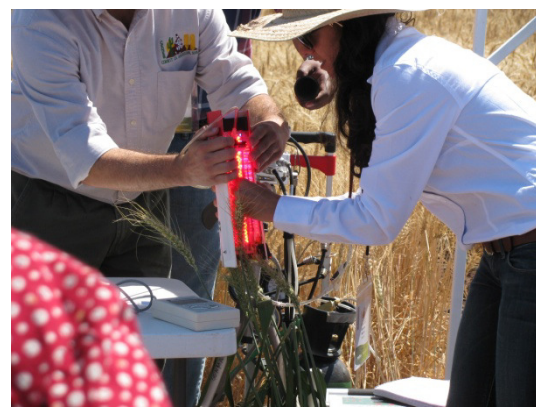
LI-COR 6400 搭配 LED 燈具，檢測小麥麥穗光合作用能力
