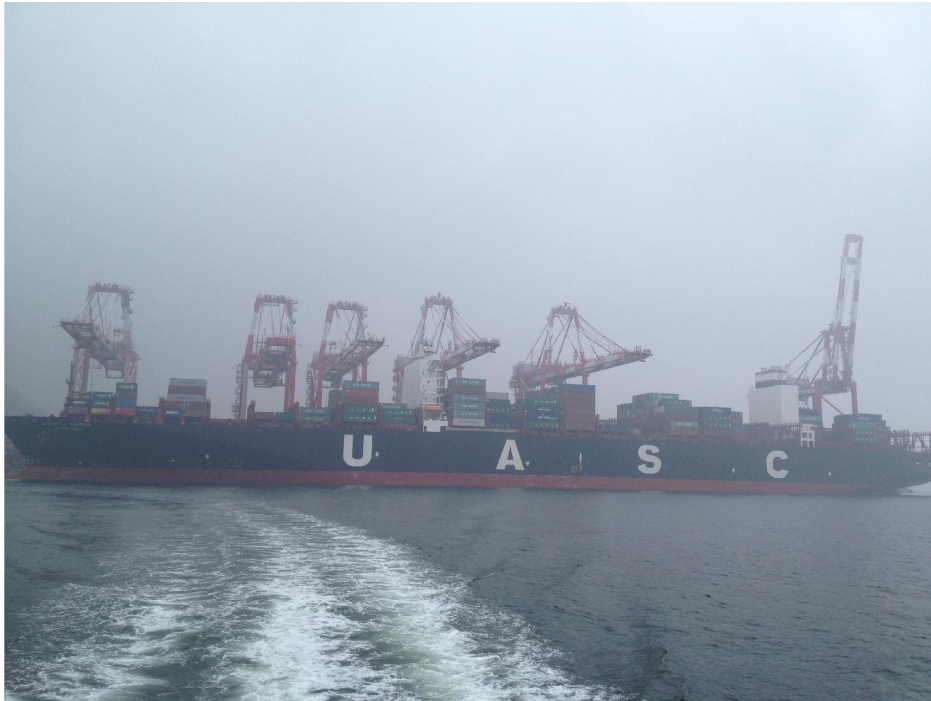
圖2.10 阿聯航運貨櫃船6座起重機同時進行裝卸作業之情景
