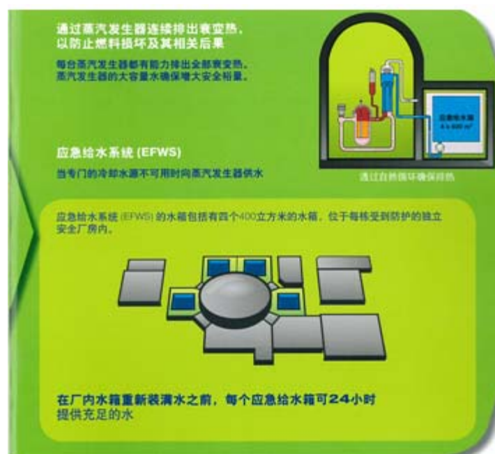
圖 5 EPR™ 反應爐的內部緊急供水系統配置圖 (資料來源：AREVA 公司廣告資料)
