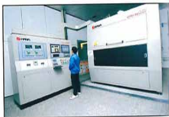
定位格架焊接
