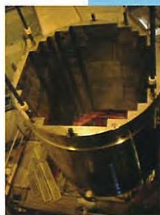
厚钢材反射层设计有助于减少燃料循环成本
