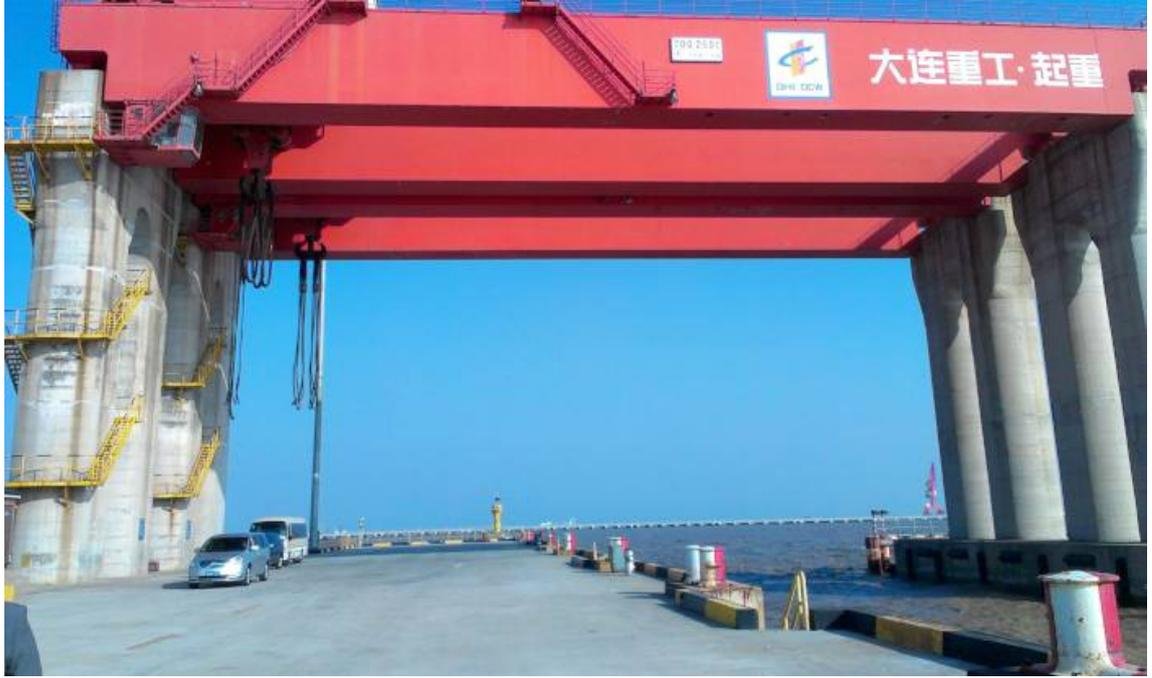
圖 12 上海電氣臨港碼頭 1400 噸級起吊機具
