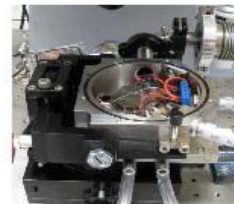
圖 3.4.3 MSA 以 RUS 技術量測非等向性彈性係數以及內部磨擦等材料性質
