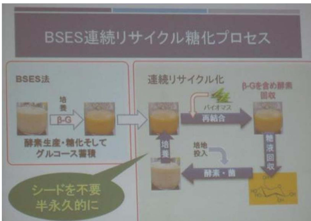
圖 30 JIRCAS 開發連續同時酵素生産和糖化法(BSES)
