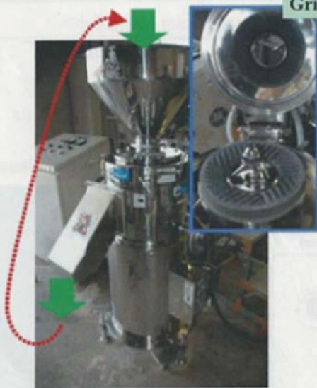
圖 10 機械研磨與水熱前處理法之設備構造
