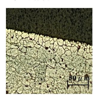
之後筆者與 Mi shur is 教授再以 $\alpha < \pi/4$  進行漸進分析,根據上述之前的實驗結果因擠製過程中強烈地塑性變形在最大摩擦表面產生出又 薄又硬的硬化層,由下圖可以看出邊界在 $\alpha < \pi/4$  不可能有滑動的可能 性,因此可知此變化層如圖所示是不可以被預測的。
