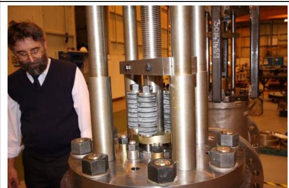
圖 16. Packing Load 組裝部份
