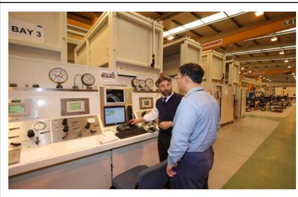
圖 18. 閥體壓力測試之控制儀器
