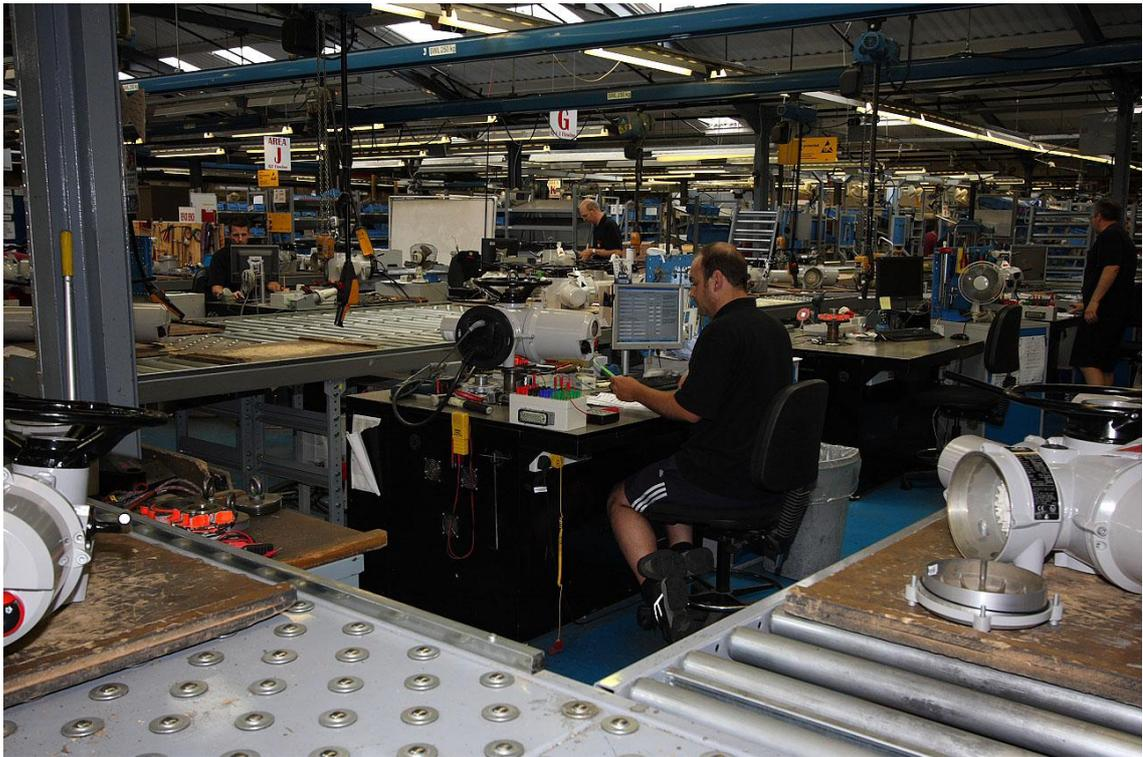
圖 3. 驅動器下線前之測試
