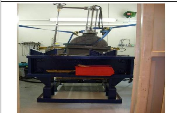
圖 17. 閥體壓力測試
