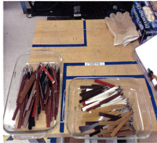
圖 10 已切割及表面處理過之樣品
