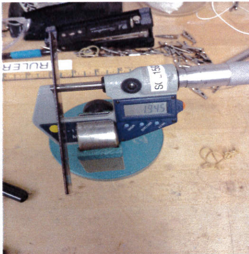
圖 18 試樣厚度測量
