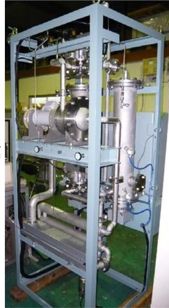
圖 3-20、氫氣乾燥器流程及實際照片
