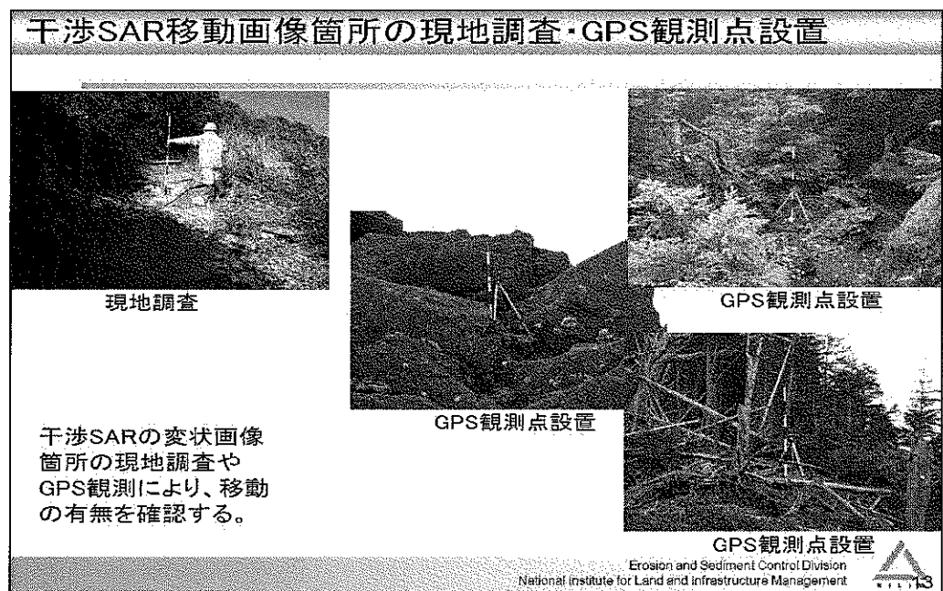
SAR 影像解析、GPS 觀測點與影像解析做比對(資料來源：簡報資料)
