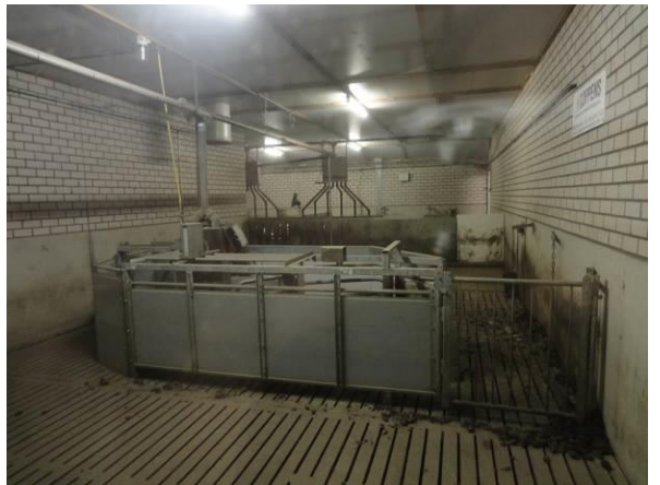
圖 40. 懷孕母豬群養之自動化個飼系統
