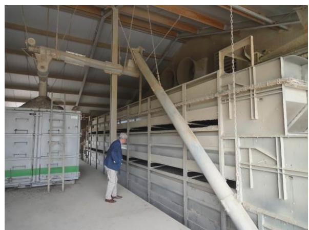
圖 20.集糞設備及雞糞乾燥設備，約 2 天自然風乾之半成品
