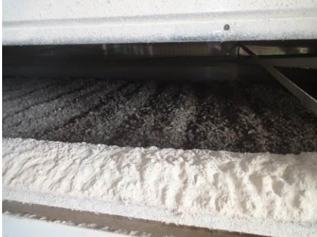
圖 20.集糞設備及雞糞乾燥設備，約 2 天自然風乾之半成品
