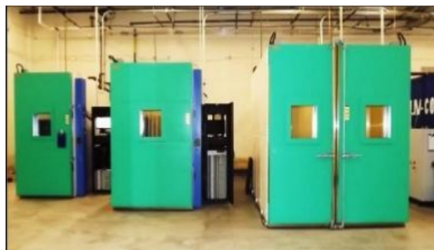
圖 4.13、全尺寸的模組機械強度測試設備
