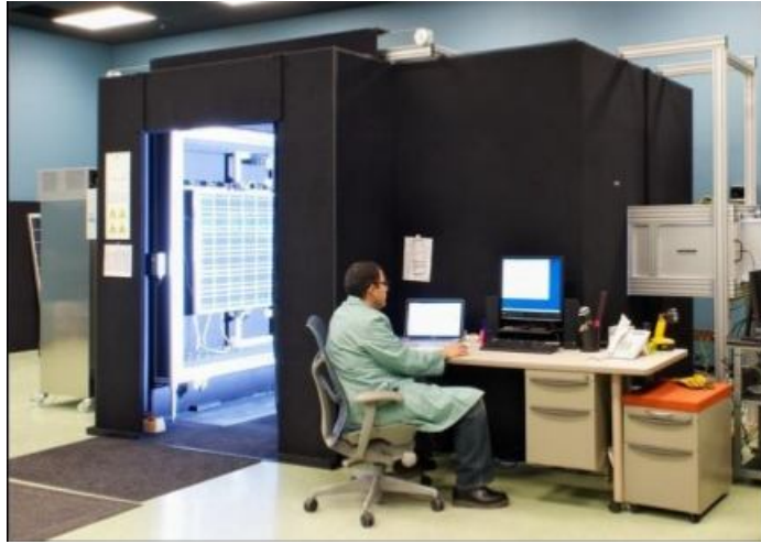
圖 4.15、全模組尺寸的室內 I-V 量測系統 [8]
