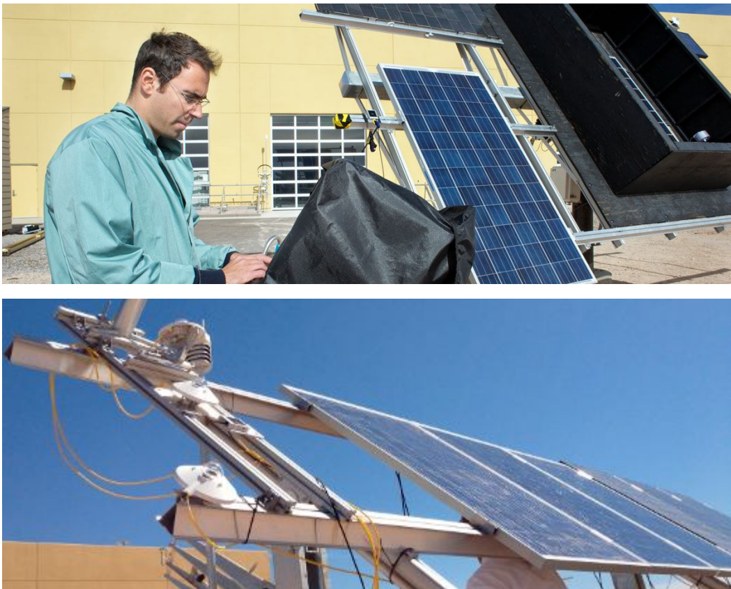
圖 4.16、戶外模組實測及追日系統設備
