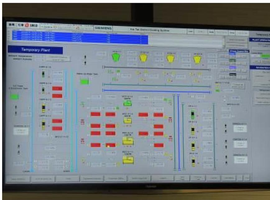
圖 136 啟德發展區區域供冷系統中心運轉監控畫面
