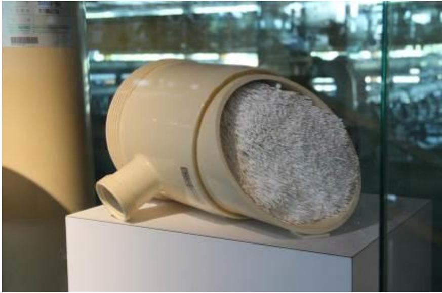
圖66 新生水工廠中在Microfiltration階段所使用之過濾材料（ZeeWeed 500）
