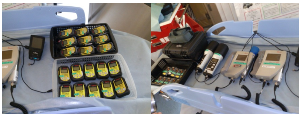
上面左圖是 REMAT 出隊時要帶出去的輻射偵測/警報器，右圖是快速核種分析儀，在國內都有類似的器材使用中。
