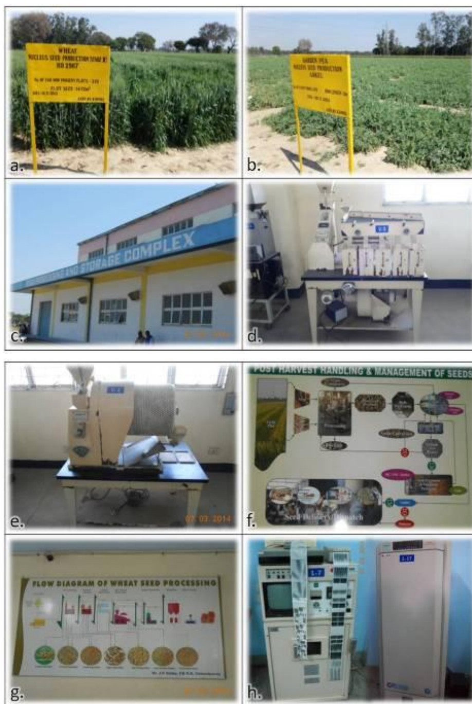
圖 14. Karnal 地區種子調製廠：a.小麥 Nucleus Seed 第二階段生產田區；b.豌豆 Nucleus Seed 第二階段生產田區；c.日印合作種子調製廠外觀；d.蔬菜種子重量選別機；e.蔬菜種子拌藥機；f.種子採收後之處理及管理流程圖；g.小麥種子調製流程圖；h.左為 X 光種子品質檢測機，右為種子發芽檢測生長箱。
