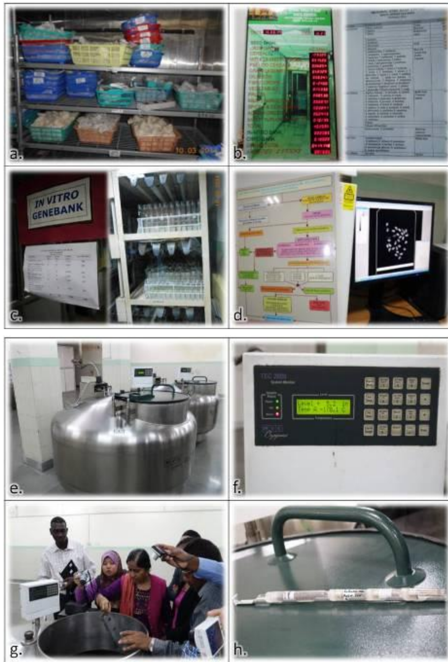
圖 9. 參訪國家植物基因資源局 NBGR：a. 低溫種子儲藏庫內部；b. 種原保存數量顯示板(左)及種子儲藏庫外張貼之索引表；c. 種原組織保存室；d. 種子檢疫流程圖(左)及 X 光病蟲害檢測儀器；e. 長期超低溫種子保存庫；f. 超低溫種子保存庫顯示面板，內部溫度約-170°C；g. 長期超低溫種子保存庫內部情形；h. 種子儲藏單元約可放置 4 管種子。
