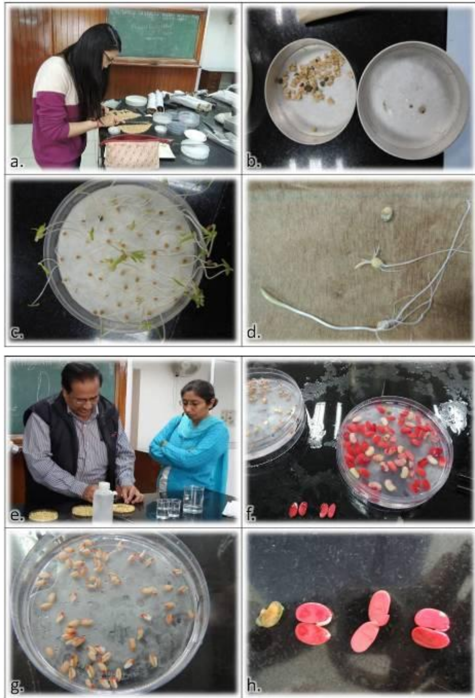
圖 6. a. 筆者進行小麥種子純潔度檢測操作情形；b. 挑揀出之雜質(左)與其他種子(右)，雜質多為破碎小麥種子；c. 番茄種子發芽試驗；d. 玉米種子以紙間法檢測發芽情形，圖示分別為死亡種子(上)、發芽不正常種子(中)及正常種子；e. 以四唑檢定法(Tetrazolium test, T.T.C.法或TZ法)檢測大豆種子活力；f. 染色完成後大豆種子；g. 染色完成後小麥種子；h. 染色後之大豆死亡種子(左1)、無活力種子(左2)及具活力種子(右1及右2)。
