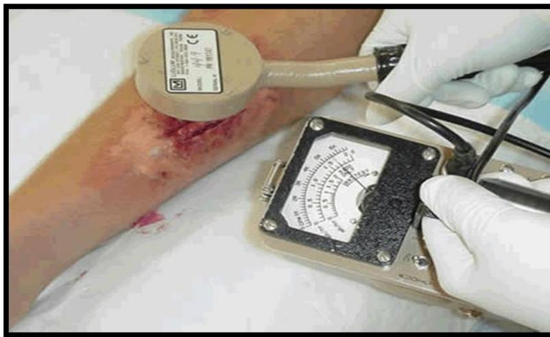
圖 3 傷口表面輻射偵測(進行後續傷口曝露途徑劑量計算)
