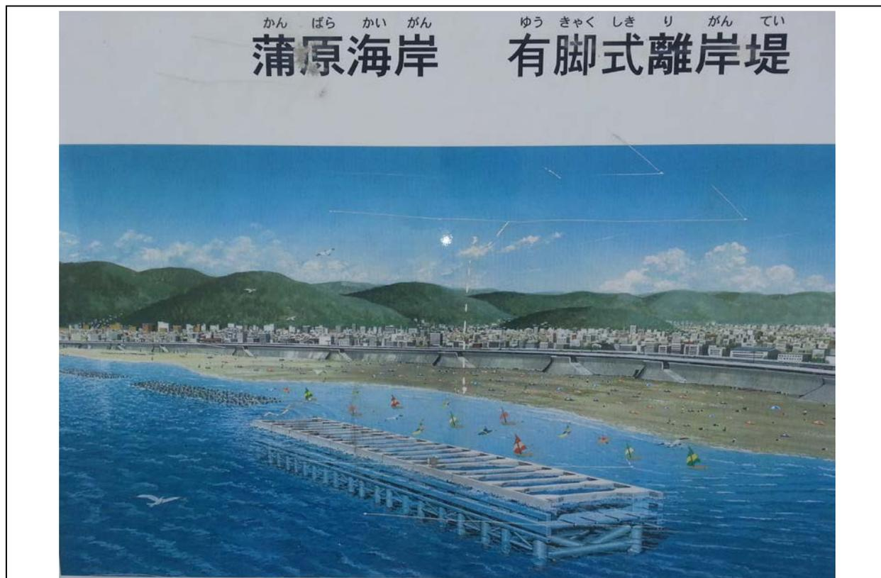
圖 14 駿河灣浦原海岸採有脚式離岸堤現場安裝示意圖(2/3)
